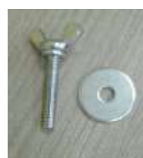
Fig. 3: Vis de fixation de l'équerre à l'appareil
